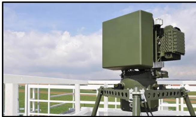
Photo 4: Radar AESA Spexer 2000 utilisé pour la surveillance en Malaisie orientale
